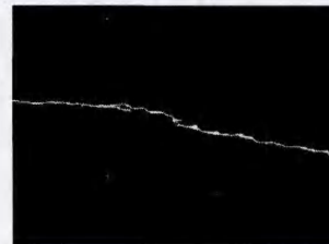
图6 后处理裂缝图像
