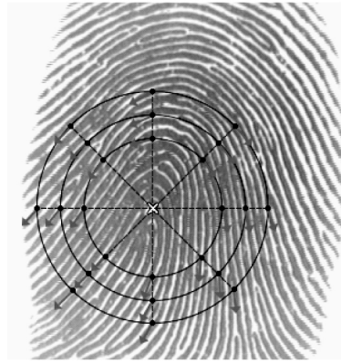
X 标记核心点区域;延伸线由虚线表示;环形结构由实线表示;圆点强调了节点位置;箭头指出了该节点处方向。
