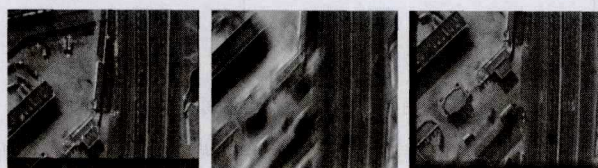
(a)经过几何变换后的彩色合成图 (b)原始输入图像均值 (c)矫正输入图像均值
