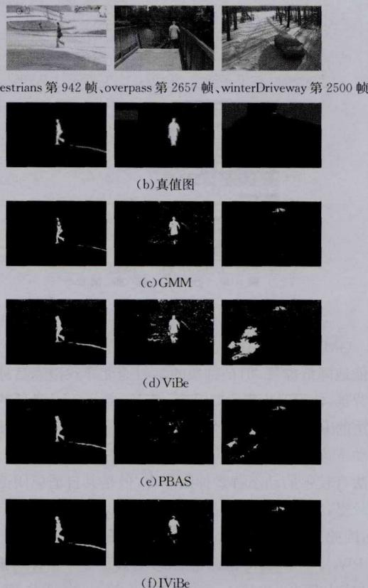
图6 GMM、ViBe、PBAS和IViBe算法的检测效果对比
