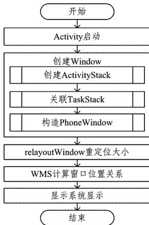
图2 窗口生成流程图
