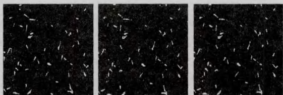
(b) 阈值分割结果 (c) 小波变换分割结果 (d) Sobel 算子分割结果
