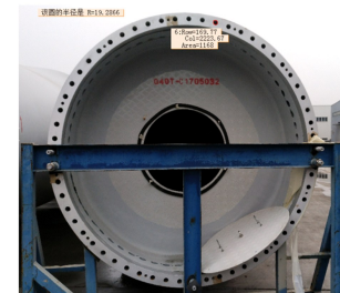
图 10 螺栓孔孔径及中心点位置检测
