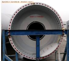
图 13 螺栓孔分布圆的圆形度及中心点位置检测
