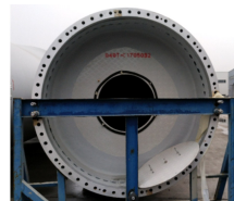
图 2 风电叶片法兰端面原始图像
