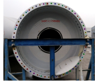
图 9 螺栓孔亚像素边缘
