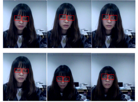
图10 实时视频图像下虹膜中心的检测和跟踪结果
