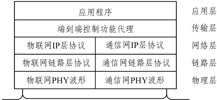
图 6 网关协议模型 Fig. 6 Gateway protocol model
