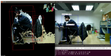
图 11 基于点云分割的算法结果
