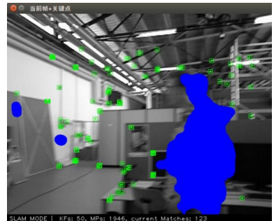
图 8 基于光流的动态点检测算法
