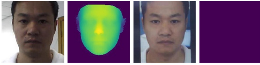
注:前两个图像是活体图像以及使用 PRNet 生成的相应的显著标签。剩下两个图像是攻击图像以及相应的扁平显著标签
