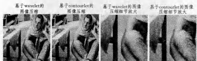
图3 Contourlet变换和Wavelet变换对灰度测试图像barbara的压缩效果
