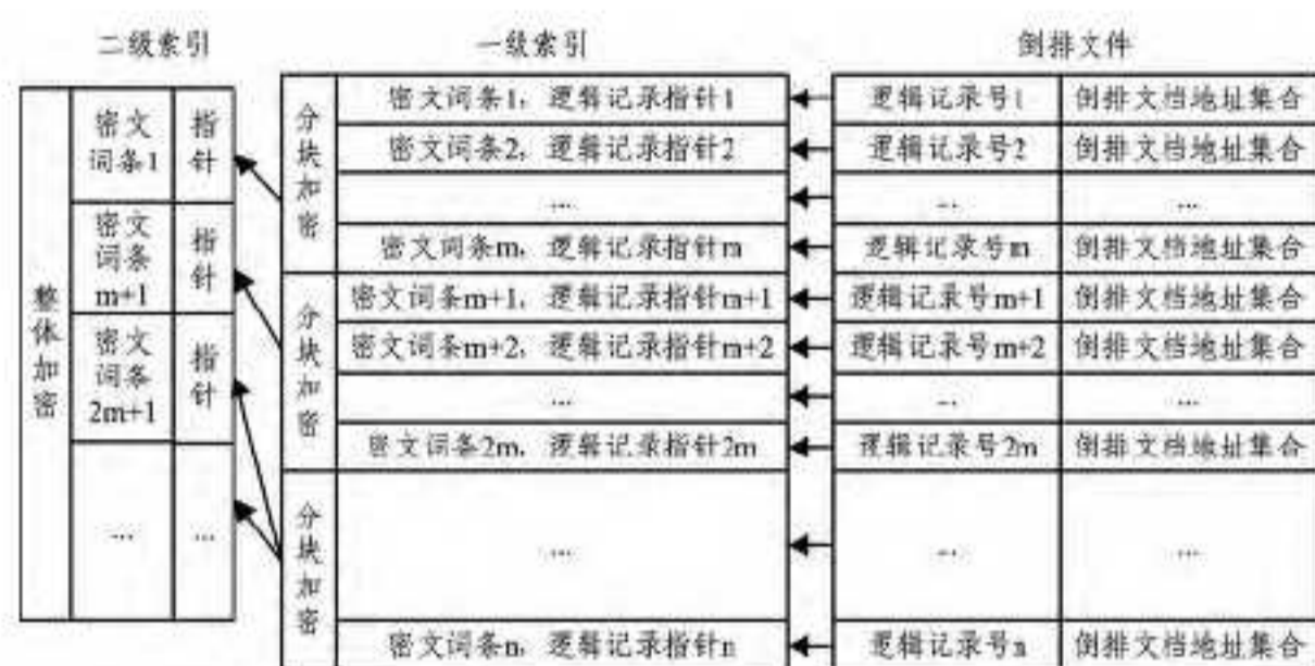
图2 两级索引结构的倒排索引
