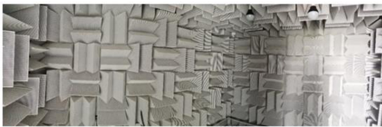
(a) 实测场景 1: 消音室(室内)
