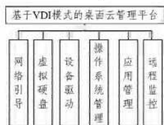
图 1 基于 VDI 模式的桌面云管理平台框架
