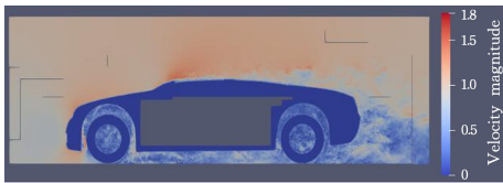
图 13 DrivAer 流场速度分布 Fig. 13 Velocity fields of DrivAer
