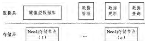
图 7 Neo4j 数据库分布式存储框架
