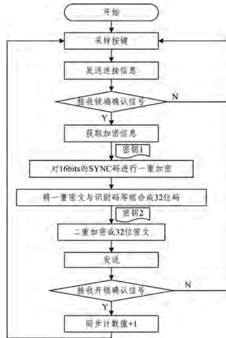
图 3 改进方案中智能钥匙端的工作流程
