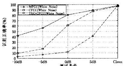
图 3 白噪声情况下 MFCC、CFCC、TEO-CFCC 特征参数识别正确率测试对比图
