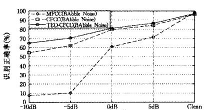
图 5 多路重合噪声情况下 MFCC、CFCC、TEO-CFCC 特征参数识别正确率测试对比图
