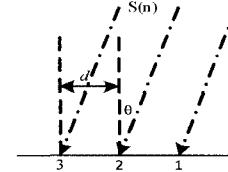
图 1 三元阵的信号相位匹配原理示意图
