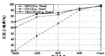
图 4 汽车噪声情况下 MFCC、CFCC、TEO-CFCC 特征参数识别正确率测试对比图
