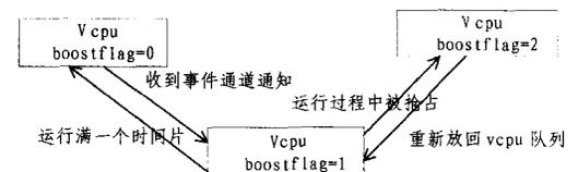
图2 vcpu状态转换
