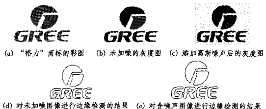
图 2 采用 Canny 算子对图像进行边缘检测的结果图
