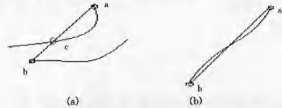
图 4 连线端点与穿越脊线数关系示意图
