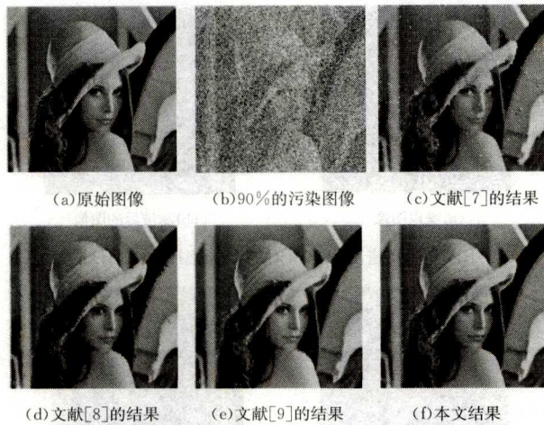
图7 添加噪声密度为90%时Lena图像采用各算法后的滤波效果图
