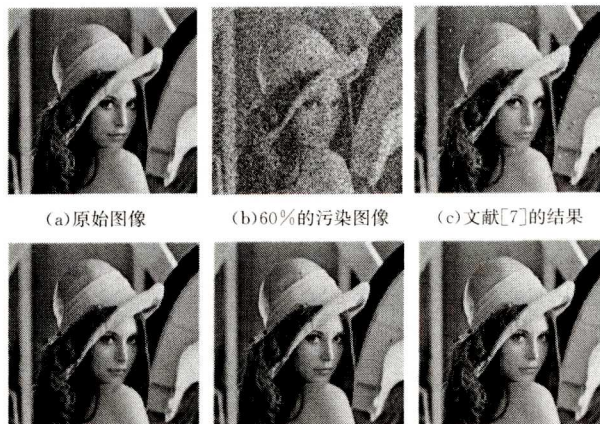
(a) 原始图像 (b) 60% 的污染图像 (c) 文献[7]的结果 (d) 文献[8]的结果 (e) 文献[9]的结果 (f) 本文结果 图 6 添加噪声密度为 60% 时 Lena 图像采用各算法后的滤波效果图
