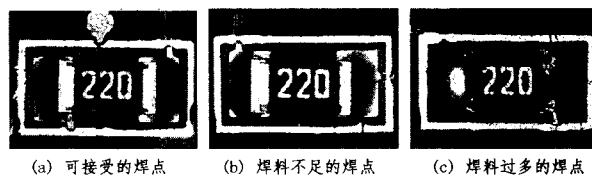
图5 SMT片式电阻及焊点图像
